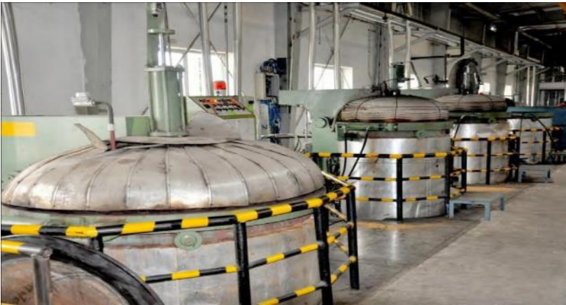
Процесс вулканизации в котле
